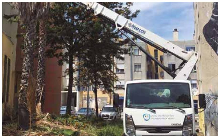
*Viatura com Plataforma Elevatória*
